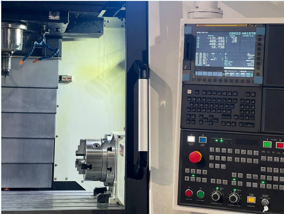
Рабочая зона и программное управление ЧПУ
